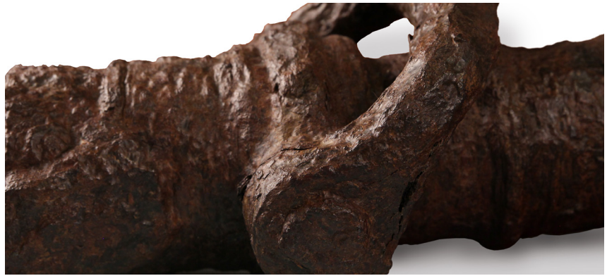
Pormenor de peça de artilharia em ferro do século XV, recolhida com um elevado estado de corrosão estabilizado quimicamente e conservado em condições de humidade e temperatura mediamente controladas.
